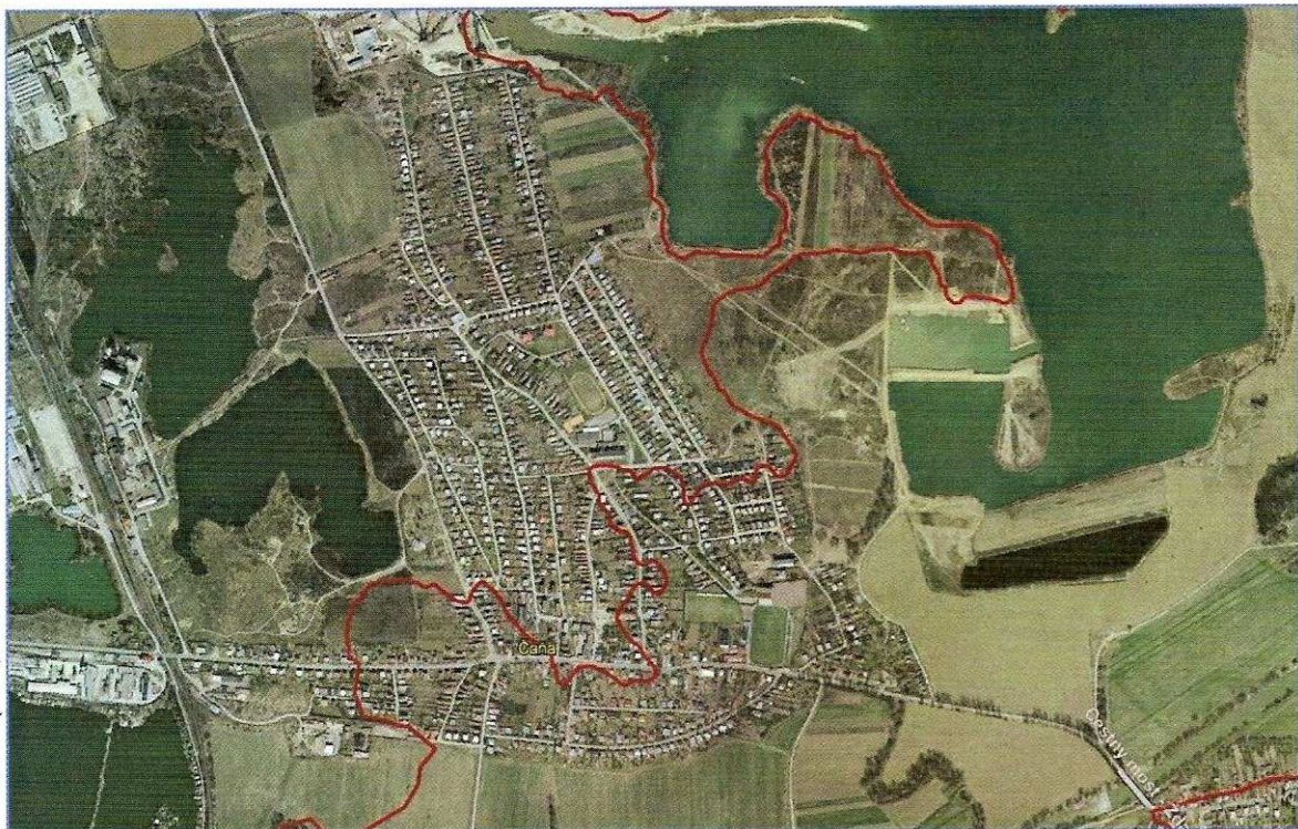
Rozsah záplavy storočnej povodne stanovený hydrodynamickým matematickým modelom – - podľa DHI SLOVAKIA s.r.o.
